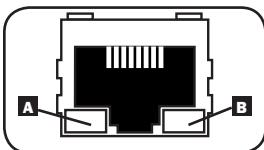
**Puerto Ethernet:** Use este enchufe RJ-45 para conectar el PDU a la red con cable patch Ethernet estándar. El LED de Encadenamiento **A** y el LED de Estatus **B** indican varias condiciones de operación de acuerdo a lo mostrado en la tabla abajo. *Nota: Este puerto no es compatible con la aplicación PoE (Power over Ethernet / Energía sobre la Ethernet).*
