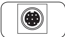
**Puerto Serial Mini-DIN:** Use este puerto para obtener una conexión Terminal directa a una computadora con un programa de emulación Terminal. Un cable serial (parte número 73-1025) se incluye con el PDU. Si necesita ordenar un cable de reemplazo comuníquese al Soporte a Clientes de Tripp Lite al 773.869.1234.
