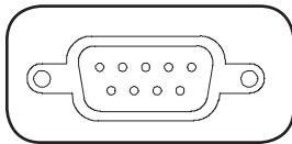
**Port d'usine :** Ce port est réservé pour la configuration en usine uniquement par du personnel autorisé. Ne rien connecter à ce port.
