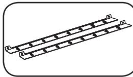
**Repisas de Retención de Cables:** Cuando está instalada en el PDU, las repisas de retención de cables arrinconan puntos de sujeción seguros para los cables de entrada y los cables del equipo conectado. Utilice las corbatas incluidas de cable para asegurar cuerdas al repisas.
