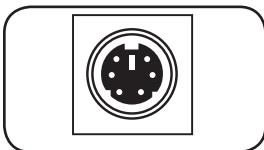
**Puerto PS/2:** Use este puerto para conectar el sensor ambiental ENVIROSENSE de Tripp Lite para monitorear la temperatura y humedad en forma remota y una interfaz de contacto seco para controlar y monitorear los dispositivos de alarma, seguridad y telecomunicaciones. Comuníquese al Soporte a Clientes de Tripp Lite al (773) 869-1234 para solicitar información. *Nota: No conecte un teclado o ratón a este puerto.*
