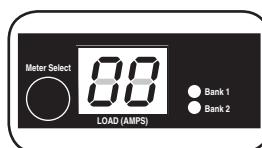
**Indicateur de charge numérique (ampèremètre) :** L'indicateur de charge numérique affiche la charge en ampères. Il peut être réglé à l'aide du commutateur pour afficher la charge totale connectée au PDU (toutes les 16 prises - les deux voyants DEL allumés) ou pour afficher la charge du banc supérieur (voyant DEL Bank 1 allumé) ou du banc inférieur (voyant DEL Bank 2 allumé) de 8 prises.
