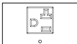
**Receptáculos de salida NEMA 5-15/20R (PDUMH20NET):** Durante la operación normal, los receptáculos de salida distribuyen la energía de CA al equipo conectado. Cuando una salida está viva se ilumina el LED asociado.
