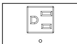
**Prises de courant de sortie NEMA 5-15R (PDUMH15NET) :** durant le fonctionnement normal, les prises de courant de sortie distribue du courant CA à l'équipement connecté. Lorsqu'une prise est sous tension, la DEL lui étant associée s'allume.
