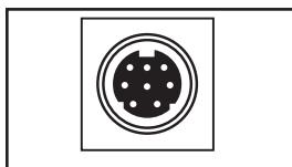
**Port série mini-DIN :** Utiliser ce port pour faire une connexion directe de terminal à un ordinateur avec un programme d'émulation de terminal. Un câble série (pièce no 73-1025) est joint à la PDU. Si vous avez besoin de commander un câble de rechange, appeler le service à la clientèle de Tripp Lite au (773) 869-1234
