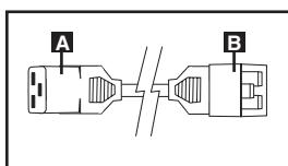
**Cable de Alimentación de Entrada CA (Modelo PDUMH20HVNET):** El cable desprendible tiene un enchufe IEC 60320 C19 **A** y una clavija IEC 60320 C20 **B**.
