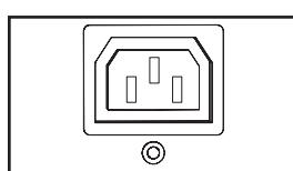
**Prises de sortie IEC60320-C13 (PDUMH15HVNET & PDUMH20HVNET) :** Lors d'un fonctionnement normal, les prises de sortie distribuent du courant alternatif à l'équipement connecté. Quand une prise est sous tension, le voyant DEL correspondant s'allume.
