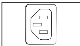
**Toma de la Energía de Entrada CA (Modelo PDUMH15HVNET):** La toma IEC 60320 C14 conecta el cable de alimentación CA desprendible.
