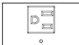
**Receptáculos de salida NEMA 5-15R (PDUMH13NET):** Durante la operación normal, los receptáculos de salida distribuyen la energía de CA al equipo conectado. Cuando una salida está viva se ilumina el LED asociado.
