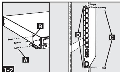
**1-3 Montage mural :** Utilisez 3 vis **A** pour fixer chacun des deux supports de fixation courts **B** à l'unité, comme illustré. Montez l'unité de distribution au mur en insérant 2 vis (ou plus, fournies par vous) **C** dans les supports de fixation **D** et dans des points de montage solides.
