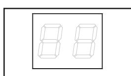
**Medidor Digital de Carga (Amperímetro):** La corriente eléctrica total utilizada por el equipo conectado se muestra en amperes en el medidor.
