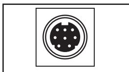
**Puerto Serial Mini-DIN:** Use este puerto para obtener una conexión Terminal directa a una computadora con un programa de emulación Terminal. Un cable serial (parte número 73-1025) se incluye con el PDU. Si necesita ordenar un cable de reemplazo comuníquese al Soporte a Clientes de Tripp Lite al (773) 869-1234.
