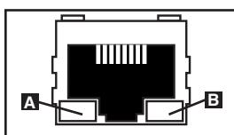
**Port Ethernet :** Utiliser cette prise RJ-45 pour connecter la PDU au réseau à l'aide d'un cordon de raccordement standard Ethernet. La DEL de lien **A** et la DEL de statut **B** indiquent plusieurs conditions de fonctionnement, comme le montre e tableau ci-dessous. *Incompatible avec les applications PoE (Power Over Ethernet).*
