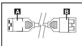
**Cordon d'alimentation en courant alternatif (modèle PDUMH20HVNET) :** Le cordon détachable a un connecteur IEC 60320 C19 **A** et un connecteur IEC 60320 C20 **B**.
