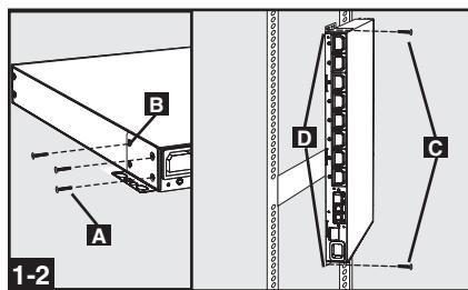
**1-3 Montaje en la pared:** Use 3 tornillos **A** para fijar cada uno de los 2 soportes de montaje más cortos **B** al PDU como se muestra. Monte el PDU a la pared insertando 2 o más tornillos, suministrados por el usuario **C** a través de los soportes de montaje **D** y en puntos de montajes seguros.
