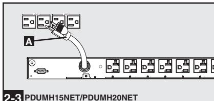
**2-3 Conecte el cable de alimentación de energía de entrada (PDUMH15NET y PDUMH20NET):** Conecte la clavija de entrada **A** a una fuente de energía de CA compatible, tal como un sistema UPS, PDU o un servicio público. Deberá proporcionarse el PDU con protección de sobre corriente: PDUMH15NET con un dispositivo de circuito ramificado de protección de máximo 15A, PDUMH20NET con un dispositivo circuito ramificado de protección de máximo 20A.
