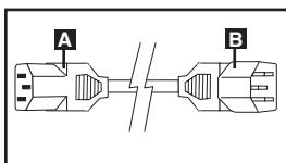
**Cordon d'alimentation en courant alternatif (modèle PDUMH15HVNET) :** Le cordon détachable a un connecteur IEC 60320 C13 **A** et un connecteur IEC 60320 C14 **B**.
