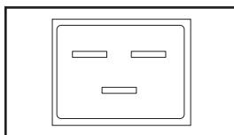
**Toma de la Energía de Entrada CA (Modelo PDUMH20HVNET):** La toma IEC 60320 C20 conecta el cable de alimentación CA desprendible.
