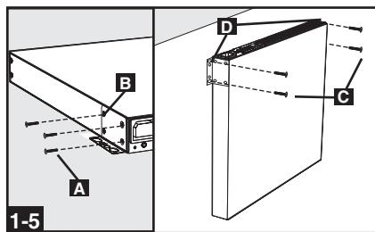
**1-6 Colocación de la Repisa de Control de Cables (Opcional):** Use 2 tornillos **A** para fijar la repisa de control de cables **B** al panel frontal del PDU.
