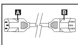
**Cable de Alimentación de Entrada CA (Modelo PDUMH15HVNET):** El cable desprendible tiene un enchufe IEC 60320 C13 **A** y una clavija IEC 60320 C14 **B**.
