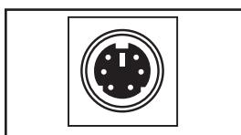
**Puerto PS/2:** Use este puerto para conectar el sensor ambiental ENVIROSENSE de Tripp Lite para monitorear la temperatura y humedad en forma remota y una interfaz de contacto seco para controlar y monitorear los dispositivos de alarma, seguridad y telecomunicaciones. Comuníquese al Soporte a Clientes de Tripp Lite al (773) 869-1234 para solicitar información. Nota: No conecte un teclado o ratón a este puerto.
