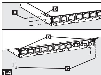
**1-5 Montaje de Fondo Reducido:** Use 3 tornillos **A** para fijar cada uno de los 2 soportes de montaje más cortos **B** al PDU como se muestra. Monte el PDU a una superficie estable con las tomas de corriente orientadas hacia arriba insertando 2 o más tornillos, suministrados por el usuario **C** a través de los soportes de montaje **D** y en puntos de montajes seguros.
