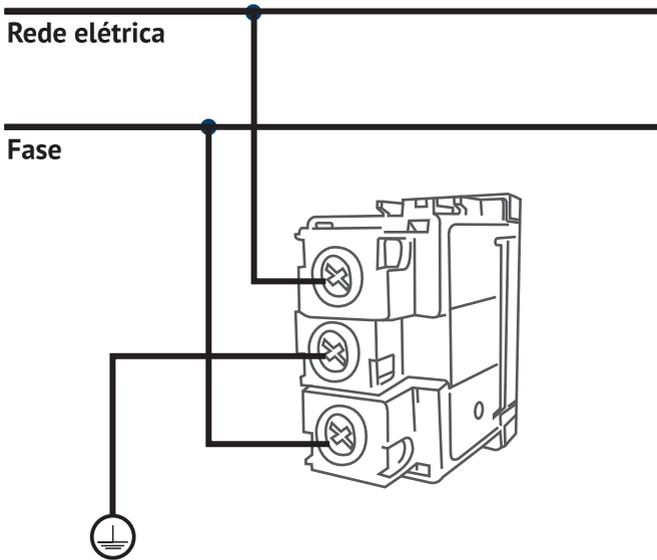
*Plugue com pinos  $\varnothing$  4mm - carga máx. 10A/250V~
