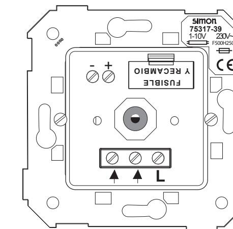
Можно отрегулировать минимальное значение напряжения на выходе, поворачивая внутренний потенциометр регулятора, находящийся на его боковой стороне. Мы рекомендуем выполнить эту операцию с помощью маленькой отвертки.
