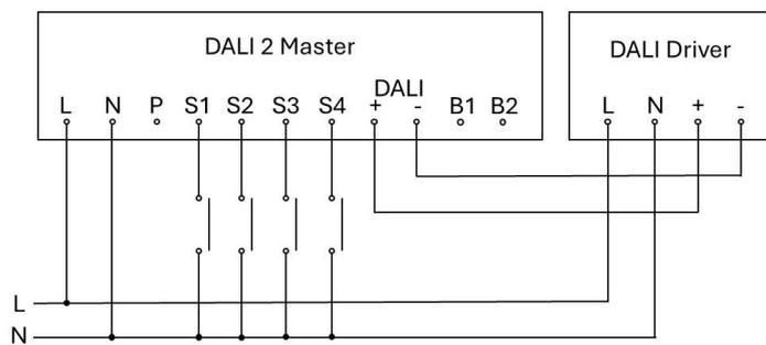
Diagrama de conexión Master/Slave con esclavo DALI-2 Input:
