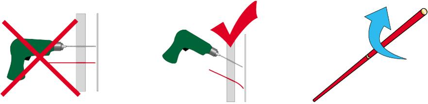
FR: Percer des trous afin de minimiser le pliage des baguettes. Tourner les baguettes pour éviter leur dévissage. En cas de pliage utiliser des baguettes flexibles.
