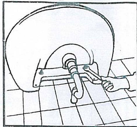
1. Montieren Sie den Waschbecken durch festziehen der Muttern.
