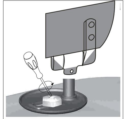
Serrare la vite con il cacciavite e con la chiave in dotazione. Successivamente rimuovere il copriwater dal fissaggio.
