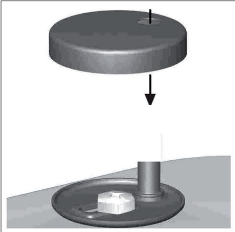
Inserire la borchietta di copertura sul fissaggio.
