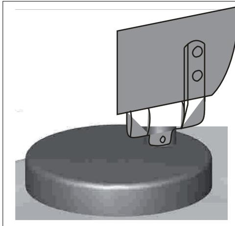
Inserire il copriwater sul pin di fissaggio e posizionare la piastrina che si trova nella cerniera sul pin. (Vedi immagine sopra). In questo modo la cerniera è stata bloccata e non potrà sganciarsi.
