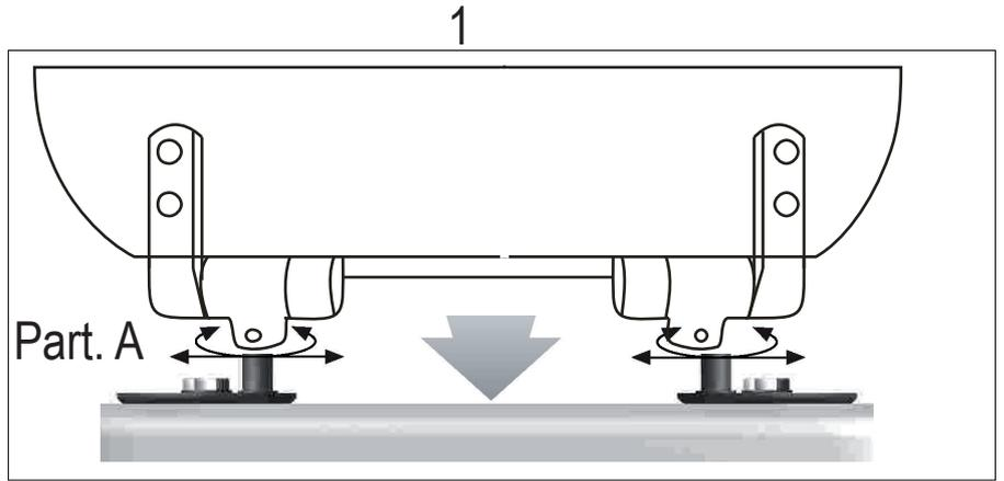
Procedere con l'inserimento del copriwater sul sanitario. Far passare la vite con Horizon ed il dado fino a che la basetta regolabile "Particolare A" non appoggia completamente sulla ceramica. Avvitare il fissaggio "Particolare A" sul vaso in prossimità dei fori con lo stesso sempre in trazione.
