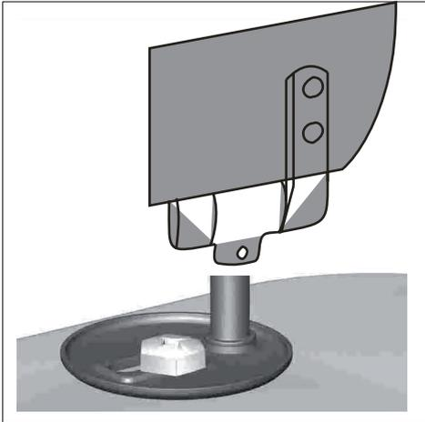
Inserire il pin del fissaggio nel foro della cerniera.
