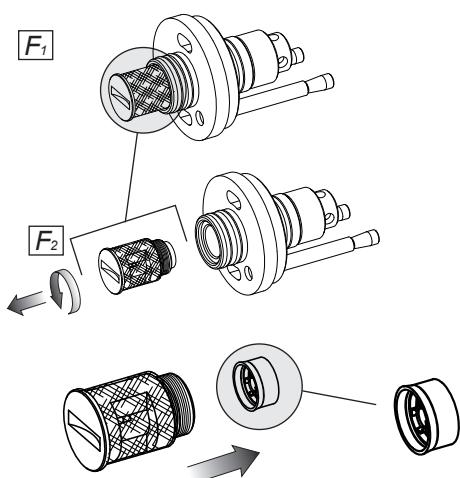
**SOSTITUZIONE VALVOLA DI RIDUZIONE DI PORTATA**
